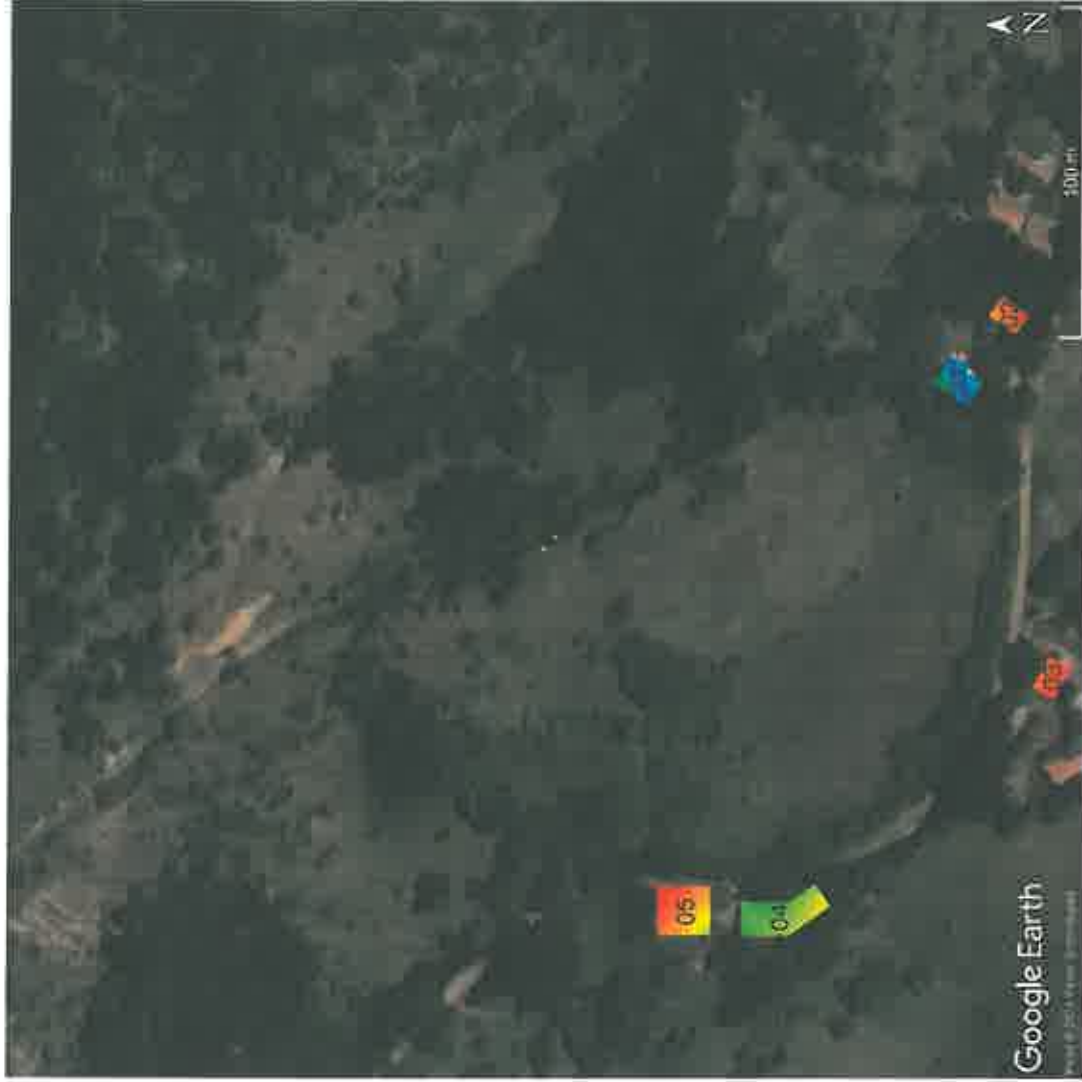
Слика 4.7. Јачина електричног поља унутар објекта када радио-систем GSM900 оператора Telekom Srbija ради максималним капацитетом
